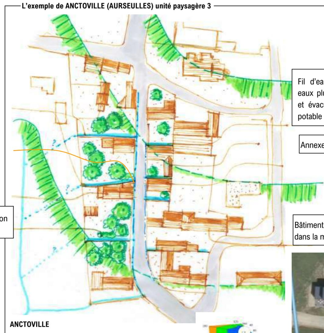
Fil d'eau de récupération des eaux pluviales de ruissellement et évacuation au réseau d'eau potable de la rue
