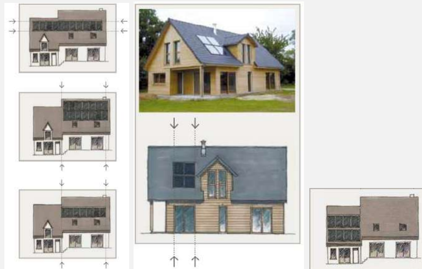
Implantation satisfaisante des panneaux photovoltaïques. Source CAUE76
